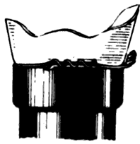
Bild 7. Neuananschluß bei Außenmetallisierung
